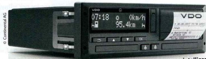
Seit Mitte 2019 müssen in Neufahrzeugen intelligente Tachos, hier der neue DTCO 4.0, verbaut werden
